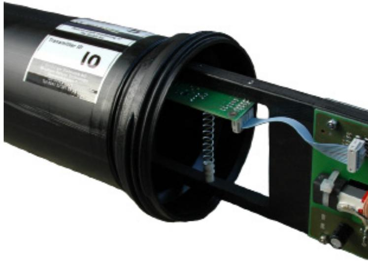
5. Avvitare il coperchio con la guarnizione in posizione corretta utilizzando lo speciale utensile (ATC Tool).
